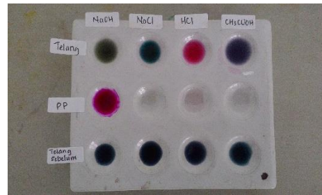
Gambar 3 Perubahan warna dari ekstrak kembang telang setelah ditetesi larutan asam yaitu HCl dan CH 3 COOH serta larutan basa yaitu NaOH dan NaCl
