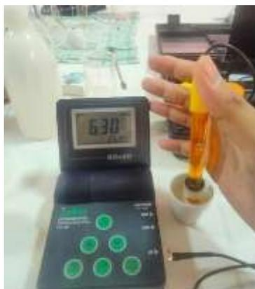
**Gambar 1. Hasil pengujian menggunakan pH meter**
