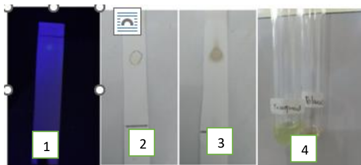
Gambar 4. Hasil rekolom dari fraksi methanol, eluen etil asetat : methanol (1:9). 1) hasil rekolom dilihat pada lampu UV 254, 2) dengan uap iod. 3)dengan pereagen LB di KLT, 4) dengan LB pada tabung reaksi.
